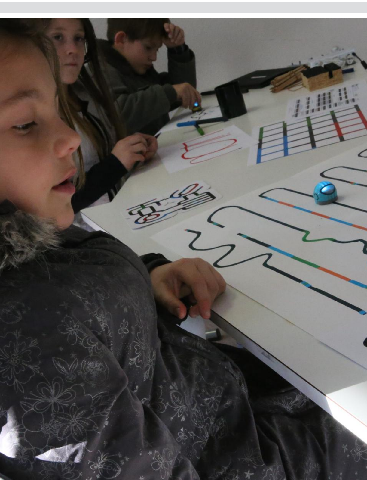
Le petit robot suit le trait noir ou réalise différentes figures en fonction de la couleur utilisée. Il va vite ou lentement, tourne sur lui-même, va à gauche ou à droite, fait demi-tour... Photos Dominique ROQUELET
